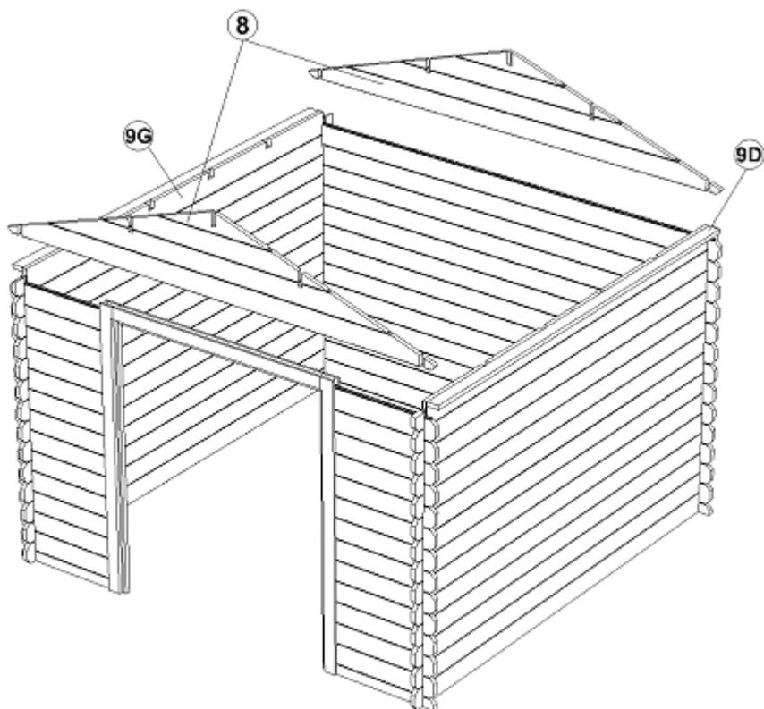
Quand les 4 parois sont prêtes, installez les 2 madriers latéraux supérieurs (pièces n°9D et 9G) ainsi que les 2 pignons, avant et arrière (pièces n°8) dans les entailles prévues.
