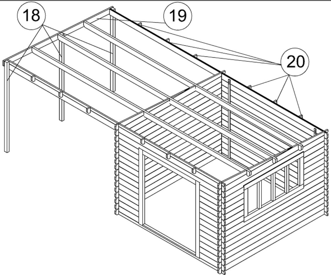
Déterminez les endroits de la pose des poteaux (l'extrémité de la panne intermédiaire et des madriers supérieurs avant et arrière). Posez et fixez les poteaux en faisant attention à bien les fixer lorsque la partie charpente est de niveau. Ensuite coupez la partie haute des poteaux selon l'angle des pannes et des madriers supérieurs. Sur les poteaux montez la poutre transversale (pièce no.19) (vis 4x50).
