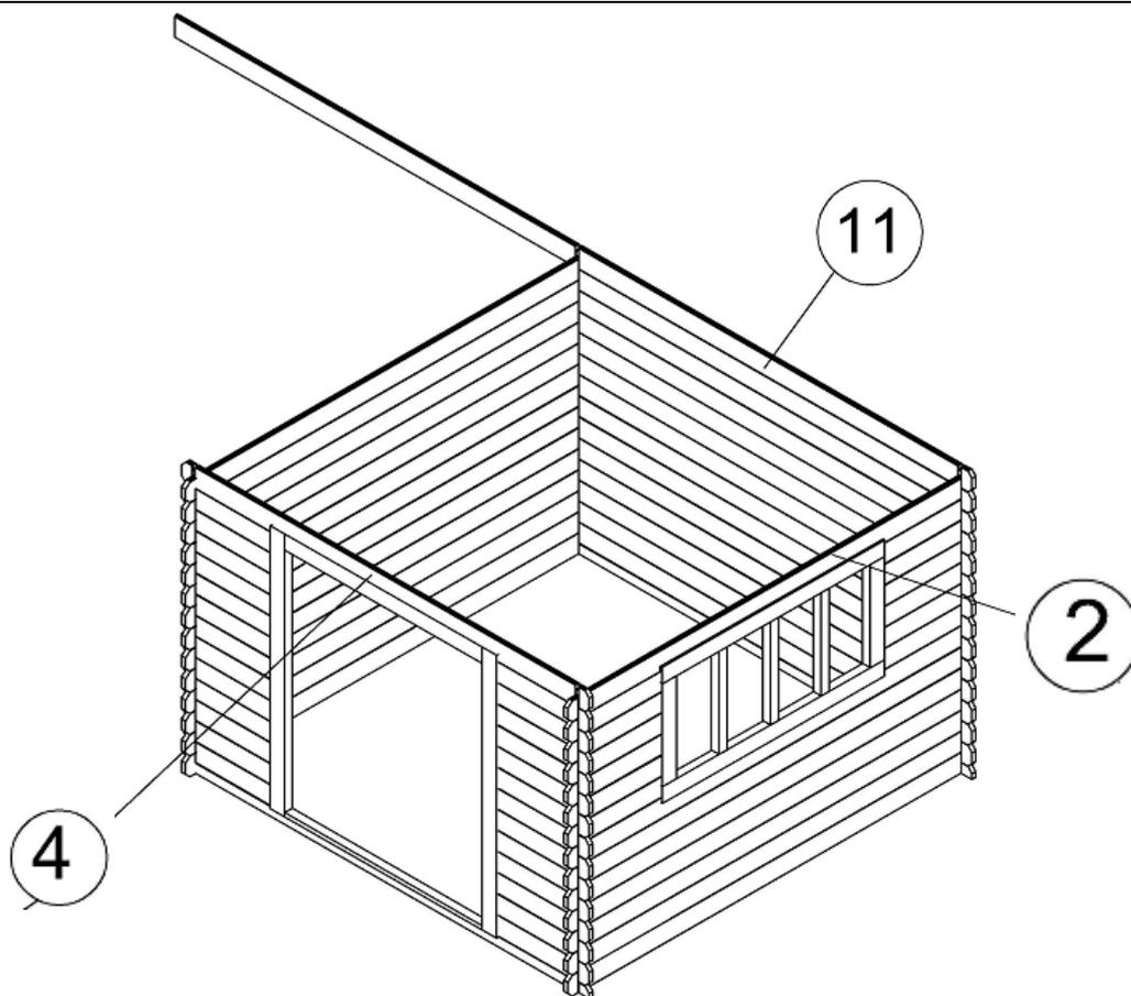
Après le montage de la fenêtre et du cadre de la porte finissez par la mise d'un madrier (pièce n°4) sur la façade avant, au dessus du cadre supérieur de porte, et le madriers latéral (pièces n° 2).
