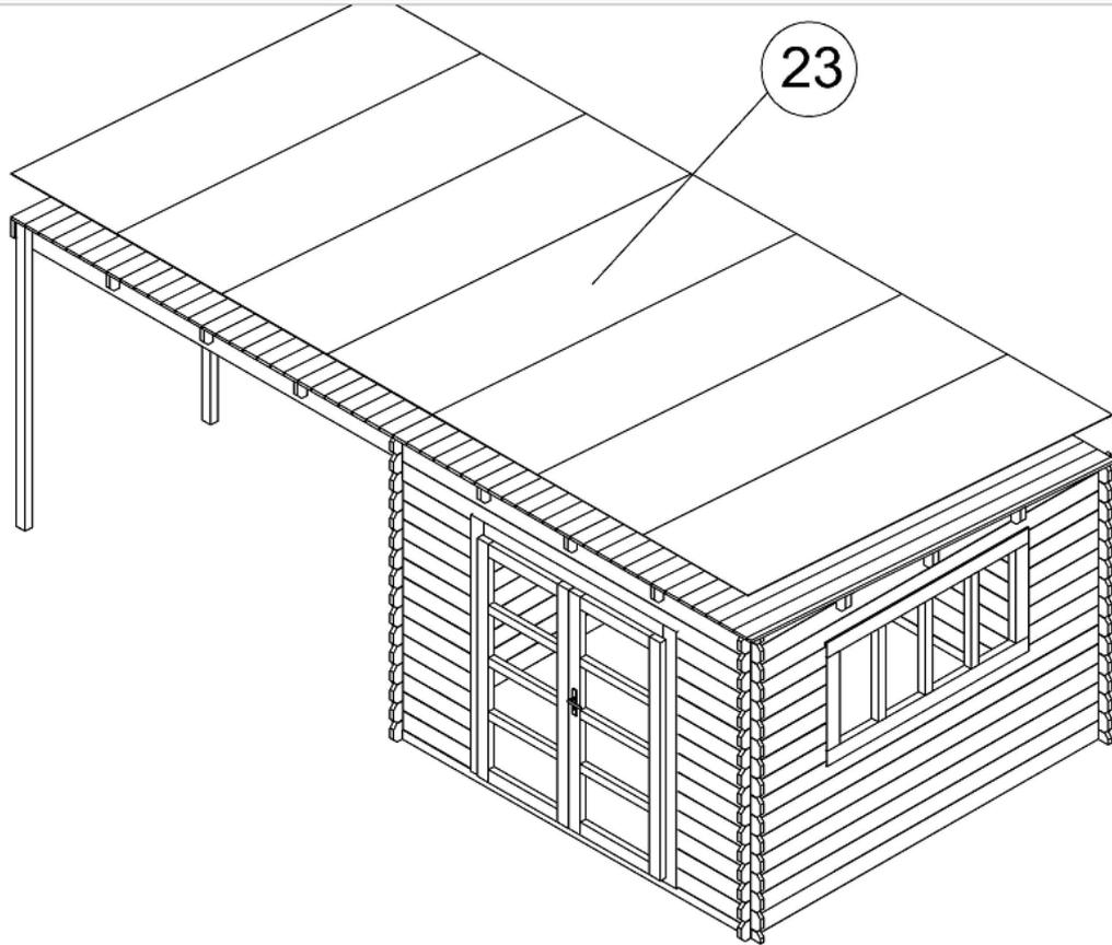
C'est le moment de la pose du feutre de toiture bitume (pièce n°23). Manipulez le feutre bitume avec précaution (et de préférence avec des gants) pour ne pas le déchirer. Vous avez 7 bandes égales de 3 m.
