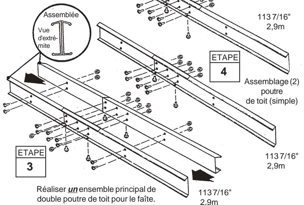
Réaliser **un** ensemble principal de double poutre de toit pour la faîte.
