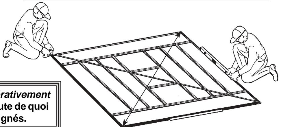
**Le cadre de plancher doit impérativement être d'équerre et de niveau, faute de quoi les trous ne seront pas alignés.**
