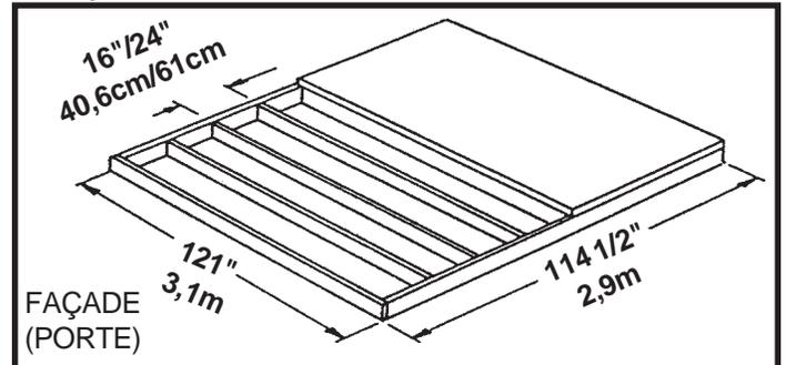
Note : Les dimensions de l'assise sont supérieures de 1,43 cm (9/16") à celles du cadre de plancher sur les quatre côtés.
